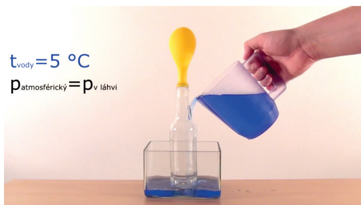
Obr. č. 2 Polévání skleněné láhve studenou vodou
